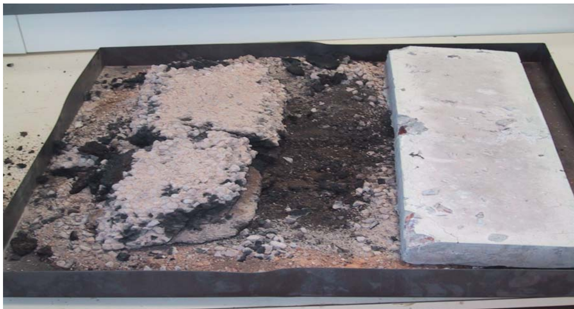
Figura 1. Comparação de provetes de asfalto (esquerda) e de betão (direita) depois de os aquecer até uma temperatura de 750° C.
