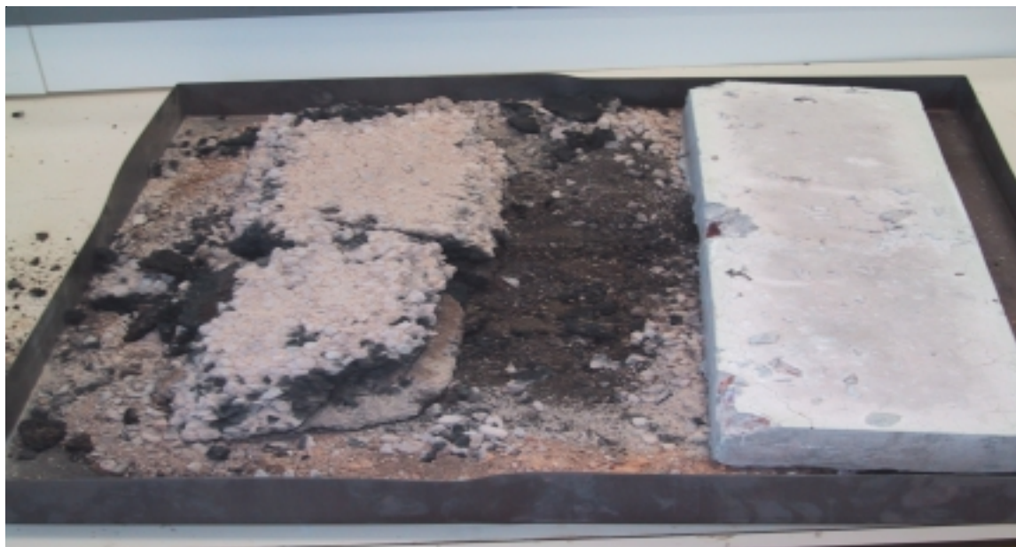
Figure 1 Comparaison d'échantillons d'enrobé hydrocarboné (à gauche) et de béton (à droite) après exposition à une température de 750°C
